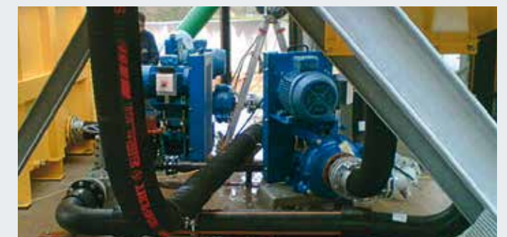
Pumpen einer STICHWEH Sandklassierung: Die Pumpen fördern Wasser-Feststoffgemische aus einem Siebunterlauf in Zyklone.
