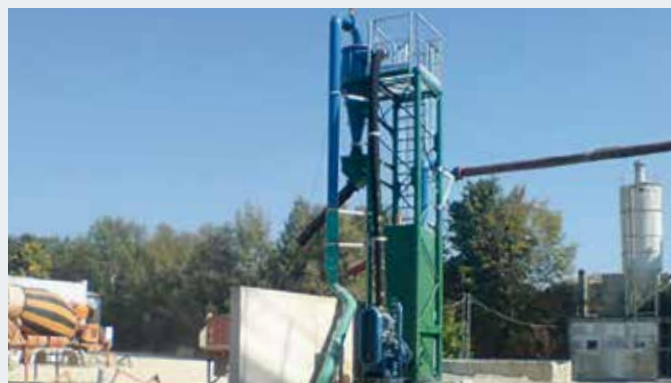
Zyklon im Einsatz zur Feinsandrückgewinnung aus dem Abwasser eines Kieswerkes Zulauf ca. 200 m 3 /h, Feststoff bis 15 t/h, Trennschnitt bei ca. 0,063 mm
