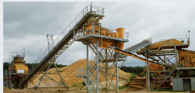
Usine de traitement STICHWEH avec CRIBLEUSE À UN ÉTAGE VS 15/40 CRIBLEUSE À DEUX ÉTAGES VS 24/60 CRIBLEUSE À TROIS ÉTAGES VS 15/50 Laveur à pales double DSW 120/2100/6000 Crible de drainage Eb 09-25-1
