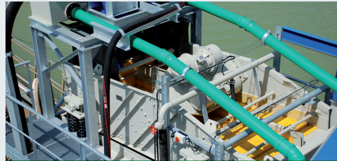
CRIBLEUSE À DRAINAGE STICHWEH EB 18/35 avec 2 voies de criblage et cyclone
