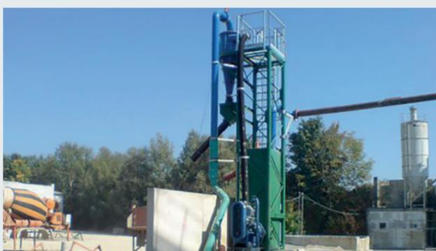
Cyclone en action pour **la récupération de sable fin dans les eaux usées** d'une gravière
