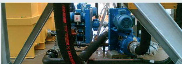
Courant inférieur de la machine de tamisage. Cyclones et pompes en action pour **le classement du sable**, avec respectivement 100m<sup>3</sup>/h
