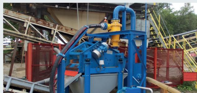
Cyclone en action pour **la récupération de sable dans des eaux usées** (nettoyage d'une bande de transport)
